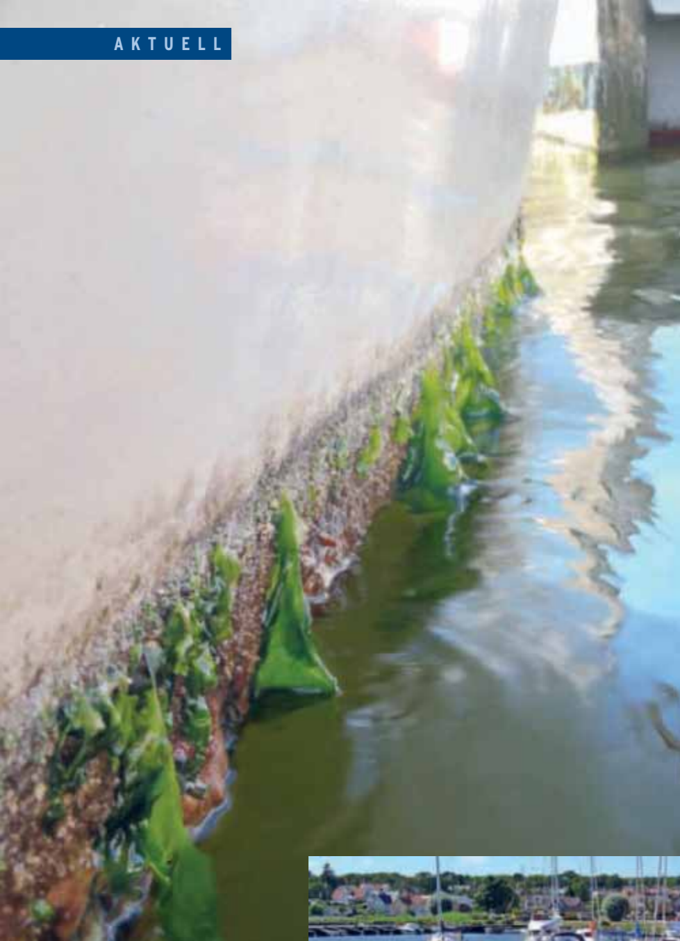
Typischer Bewuchs für Boote ohne Antifoulingwirkung im Salzwasser. Es wachsen sogar Algen. Bootswaschanlage in Schweden. Die Anlagen an der schwedischen Ostseeküste werden überwiegend von Motorbooteignern genutzt. Gegen den Bewuchs hilft auch das Reinigungsgerät „Tausendbein“.
