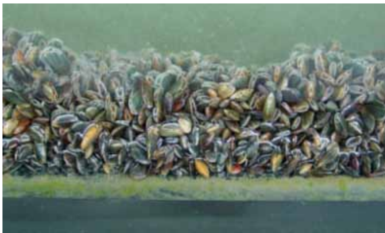
Wirkungslos: Miesmuschelbank auf einer Antifouling-Testplatte des Forschungsinstituts LimnoMar im Nordseewasser. Ohne Biozide geht es noch nicht..
