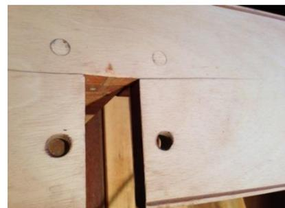
Klebstoff und wird extrem hart und steif. Es kann somit die Festigkeit des Rumpfes unterstützen. Zum Beispiel hat die vordere Bank, in der die Mastführung integriert ist und deshalb sehr belastet wird, auf beiden Seiten einen kleinen Riss. Wenn ich diese nun mit Epoxidharz verklebe, muss ich nicht die ganze Bank auswechseln.
