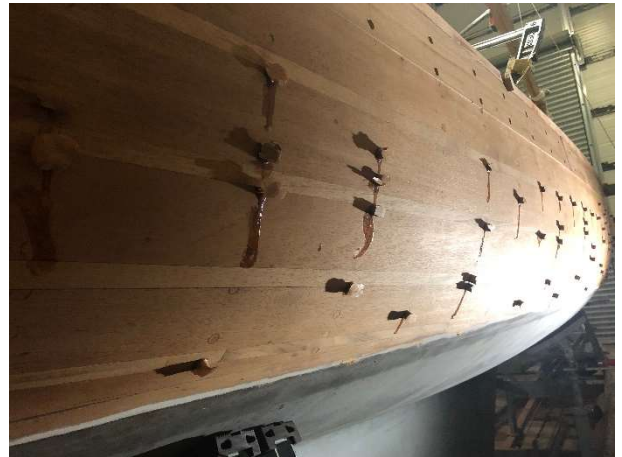
Ausgeleisteter und neu verproppter Rumpf
