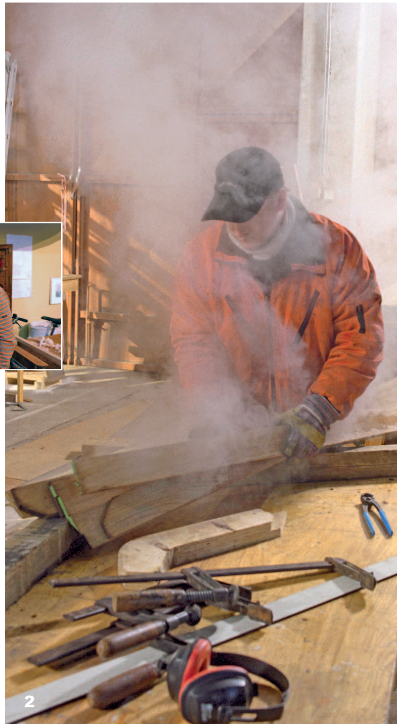
Hitze und Wasserdampf gehören dazu (2). Bootsbaumeister Willi Stapelfeldt (1) hat lange Erfahrungen mit dem Verformen von Spanten (3). Die Ergebnisse des traditionellen Bootsbaus mit Dampf von einfacher Ausführung (4) bis hin zur hohen Perfektion: Süll aus Edelholz eines Daysailors (5).
