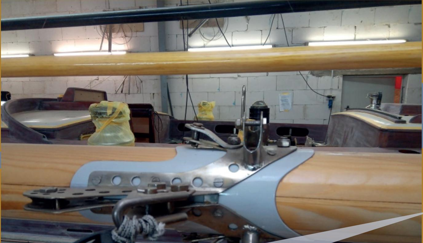
fen. Z.B. weil jemand eine Antenne oder Beleuchtung nachgerüstet hat und sich dachte „das Kabel kann ich ja gut im Mast verlegen, der ist ja hohl!“ Wenn diese Kabel nun am oberen Ende nicht 100% abgedichtet sind, kommt Feuchtigkeit in den Mast und greift das Holz von innen an.
