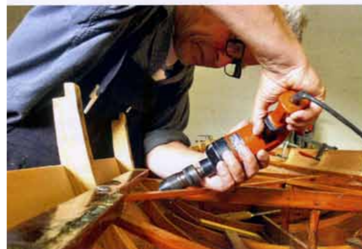
Der Gebrauch von Kupfernieten in der Leichtbauweise von geklinkerten Rümpfen erfordert jede Menge Erfahrung und wegen Platzmangel für den Einsatz des Nietwerkzeuges oftmals alternatives Werkzeug.
